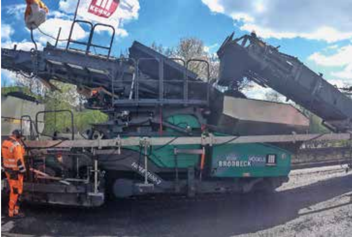
Die offene Architektur der asphalt solution erlaubte die notwendige Anpassung des Prozesswerkzeugs auf die Anforderungen der Kompaktasphaltbauweise
